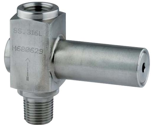
Ces dispositifs protègent les manomètres et les pressostats montés sur des circuits produisant des surpressions élevées. Lorsque la pression dépasse accidentellement la valeur maximale admise, le limiteur isole automatiquement l'appareil du circuit et le réintègre automatiquement lorsque la pression du process est stabilisée. La valeur d'intervention est tarable sur une étendue de temps plus large.
